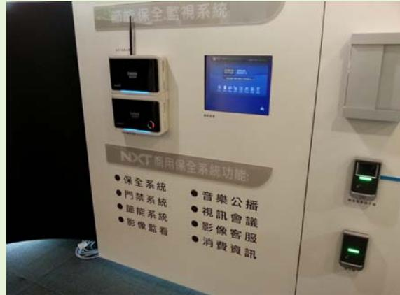
此為中興保全的辦公室節能系統部分，左圖利用虛擬環境+實體設備呈現中興可以提供的服務，包含了辦公室用電量、保全、門禁、視訊會議等功能，將這些服務整合成一個完整的系統，節能的部分安裝了智慧電表、溫溼度感測器、二氧化碳濃度感測器，透過收集到的資訊，管理者可以做出節能政策。
